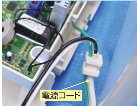
電源コードを取り付ける
